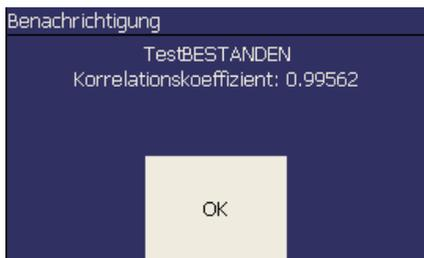
Das Ergebnis dieser Validierungsprüfung wird dann im Untermenü Systemwerte (Kap. 6.4.2) aktualisiert. Auch die NIR-Messprotokolle aller anschließenden Messungen weisen dieses Validierungsergebnis im Abs. „Letzte Systemprüfung“ bis zur nächsten Validierung bzw. Justage aus.
