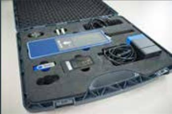
Lieferumfang: apotec® NIR-System, hochwertiger Koffer für Transport und Aufbewahrung, Ladegerät, USB-Kabel, Probenschale, USB-Stick und MessCube.
